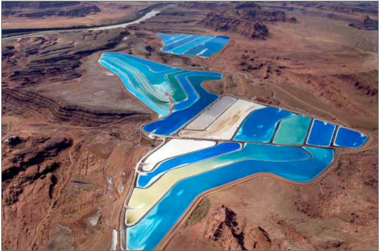
Bassins de décantation qui utilisent l'eau du fleuve Colorado pour la récupération de la potasse © Pete McBride
